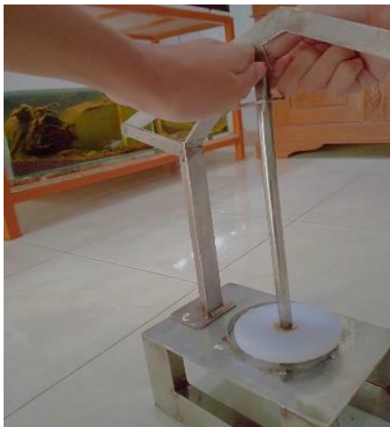
Gambar 3. Pemasangan Penampang Penekan
