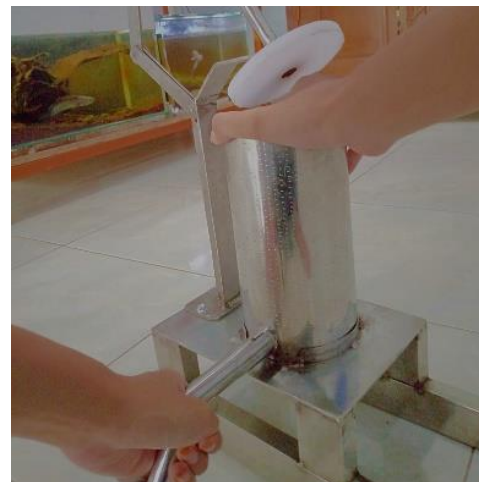
Gambar 5. Pemasangan Tabung pada Dudukan
