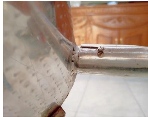
Gambar 4. Pemasangan Corong pada Tabung
